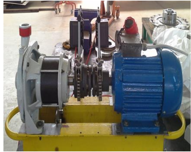
الشكل (2) يوضح وحدة مضخة الطرد المركزي
